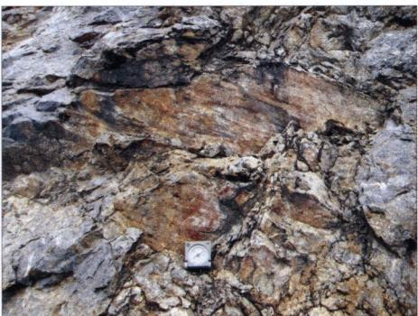
Obr. 6. Zlom V – Z smeru ( $178/80^{\circ}$ ) s výraznými lineáciami ( $90/15^{\circ}$ ) – sinistrálny pokles, kameňolom severozápadne od obce Drienovec
