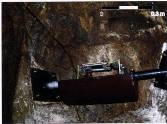
Obr. 8. Meradlo TM71 v Zbojníckej jaskyni. Prístroj je umiestnený naprieč zlomovou poruchou  $245^{\circ}/65^{\circ}$  vystupujúcou v pozadí prístroja (podľa Briestenský a kol., 2007)
