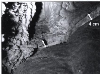
Obr. 4. Poklesávanie blokov v hornej časti jaskyne Slopy dokumentuje čerstvá odtrhová hrana s preukázanou veľkosťou pohybu 4 cm. Foto: M. Briestenský
